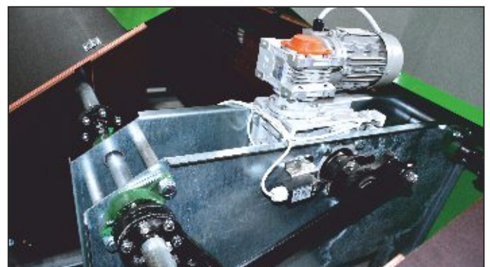
moduł otwierania gniazd z czujnikami krańcowymi o ruchu mimośrodowym
