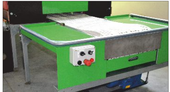
stół odbiorczy wyposażony w napęd taśmą ze sterowaniem
