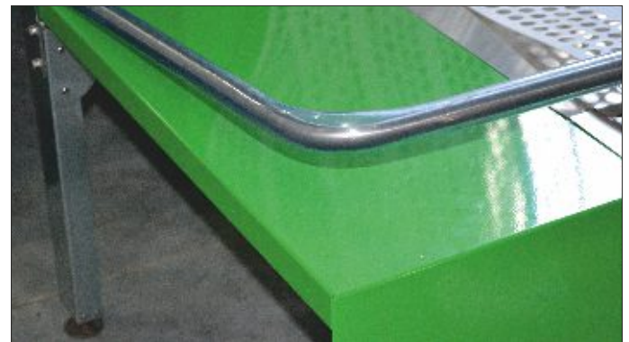
ruchome zabezpieczenie rurowe, po uniesieniu pozwala na łatwe oczyszczenie stołu odbiorczego
