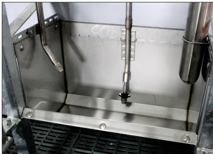
koryto proste wysokie w sektorze porodowym z systemem karmienia Gestal Solo
