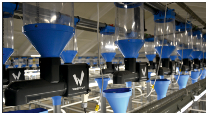
elektryczne dozowniki paszy w sektorze krycia
